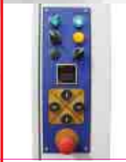
8 Pannello comandi con funzionamento manuale/semiautomatico/autom. Control panel for manual/semi-automatic/automatic operating Panel de mandos con funcionamiento manual/semiautomático/automático
